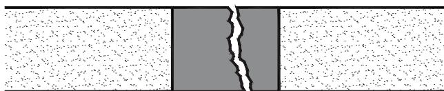
Figura 8.2. Falla cohesiva de sellador.
