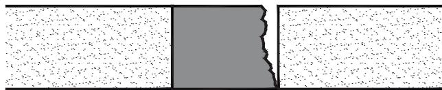
Figura 8.1. Falla adhesiva de sellador.
