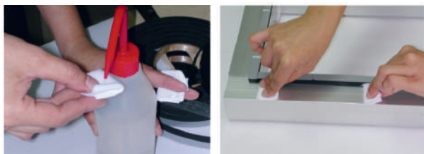
Figura 8.15. Limpieza de sustratos con el método de los "dos paños" e IPA.
