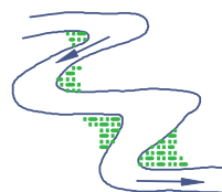
Cobertura en lado interno de curvas
