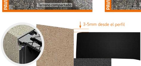
El pavimento circundante y el dado de hormigón deberán de quedar en un plano entre 3 y 5 mm por encima del plano del borde superior del canal, tal como se muestra en el diagrama.
